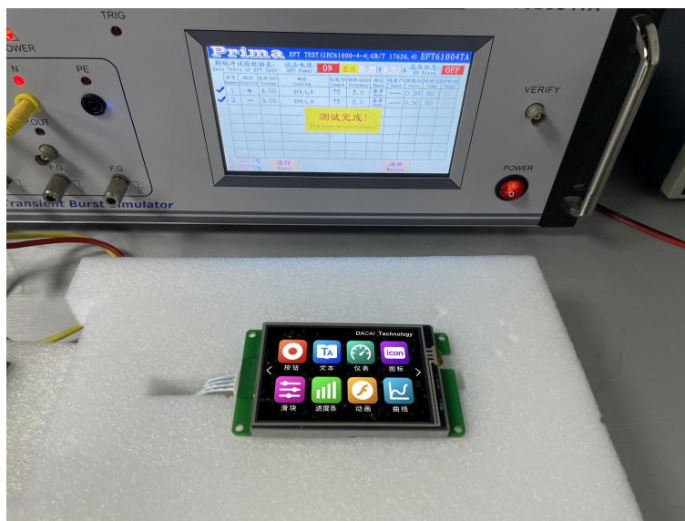
图 5-4 群脉冲测试图
