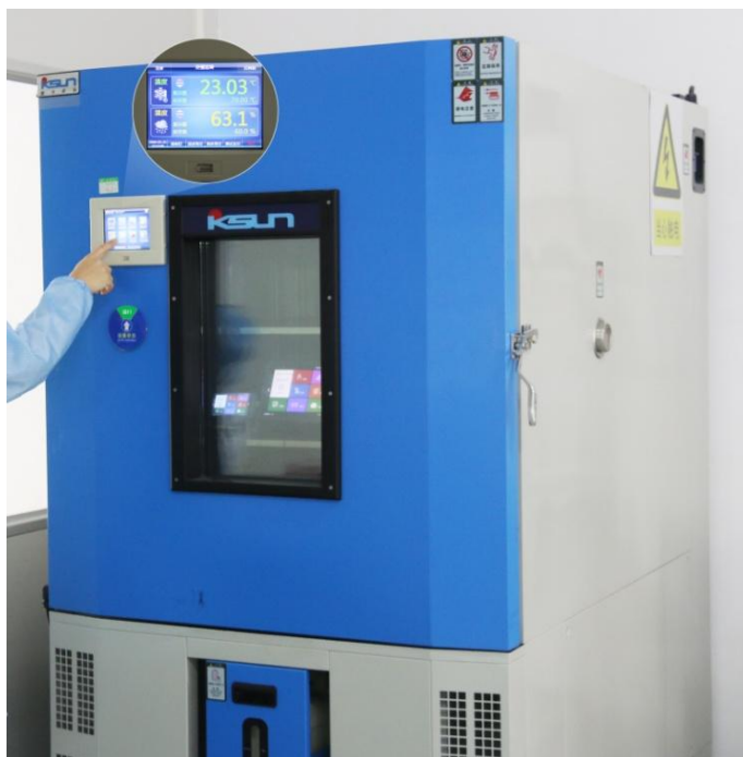
图 5-3 高低温老化测试图
